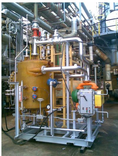
Figura 27 – Unidade de Unidade de Extração de Gás do Solo.
